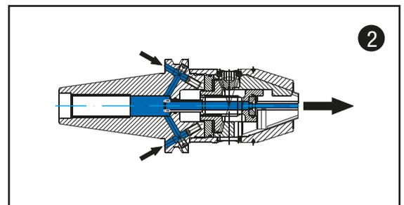
Somit öffnen die Gewindestifte die Kühlmittelversorgung. Maschinenseitig wird das Kühlmittel durch den Anzugsbolzen ohne Kühlmittelbohrung abgedichtet.
