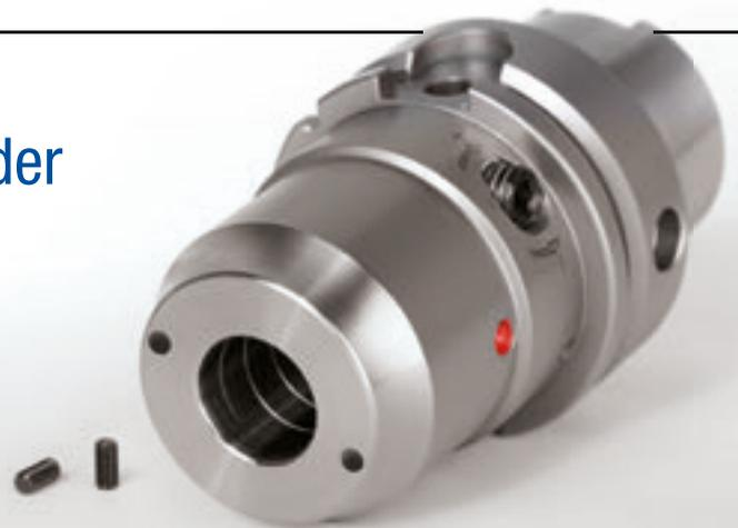
Das WTE HPH in kurzer schwerer Ausführung besitzt eine ausgezeichnete Steifigkeit, hohe Drehmomentübertragung und hält hohen thermischen Belastungen bis 120 °C stand, wie sie zum Beispiel beim HPC-Fräsen vorkommen. Die Biegesteifigkeit beträgt dabei das 1,4-fache gegenüber einem herkömmlichen Schrumpffutter. Zusätzlich bietet WTE das HPH als kurze schwere Ausführung mit wiederverschließbaren Kühlkanalbohrungen an. Damit ist der Einsatzbereich
