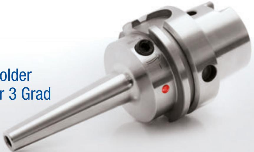
Mit dem HPH 3° Multi mit schlanker Kontur ist WTE eine Revolution in der Spanntechnik gelungen. Erstmals ist es dank der additiven Fertigung möglich, die Vorteile eines Hydro-Dehnspannfutters in einem noch breiteren Anwendungsspektrum zu nutzen. Zum einen weist das neue Spannfutter die schlanke Kontur mit der vom Schrumpffutter bekannten Verjüngung von 3 Grad sowie den bekannt hohen Haltekräften auf, erspart aber teure Schrumpfgeräte.
