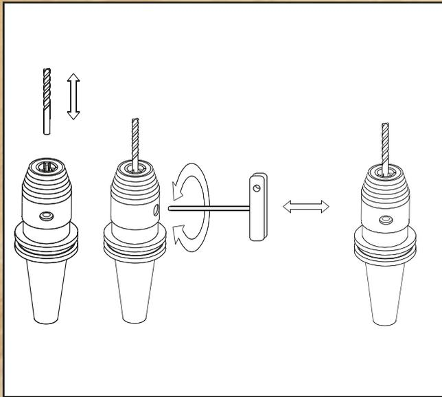
1. Öffnen der Spannbacken entgegen des Uhrzeigersinns zum Einlegen des jeweiligen Schneidwerkzeuges.
